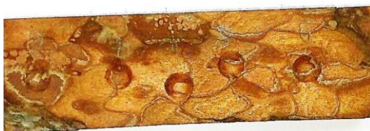
Рис. 2. Образец для испытания с корой
