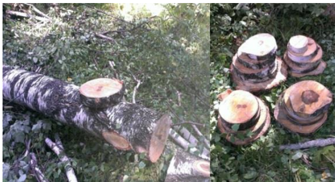
Заготовка торцовых срезов
